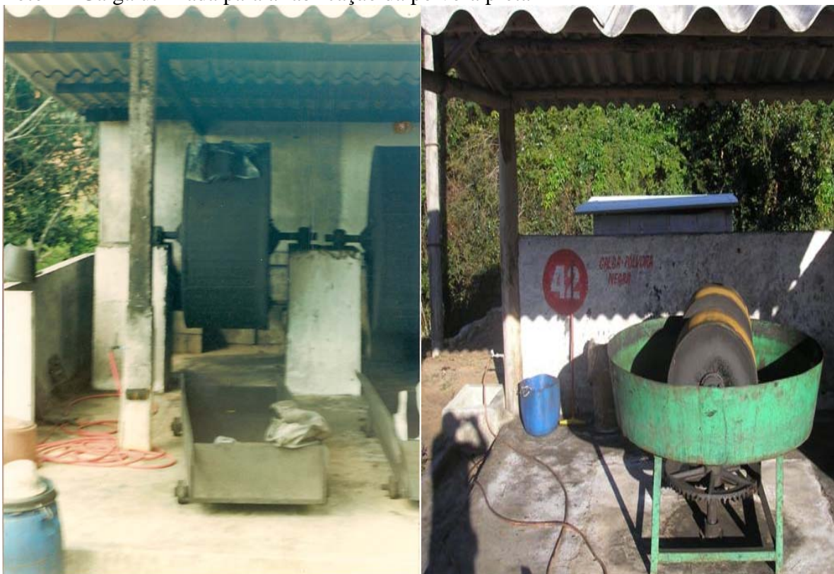
Foto 4 - Galga utilizada para a fabricação da pólvora preta
